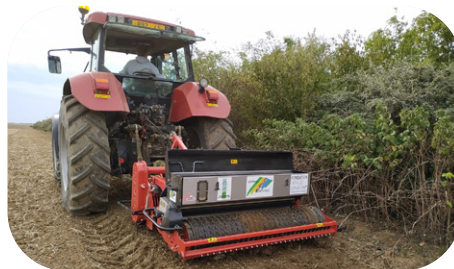
Outil Sem'A Flore tracté/déporté (concepteur : Rotadairon).
